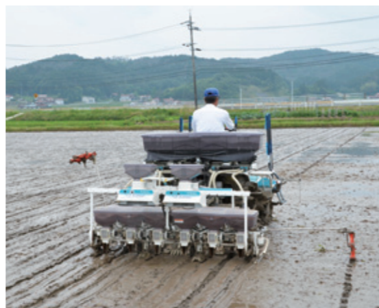
写真4 鉄コーティング種子の点播 粒剤の散布機を2台取り付けて除草剤ピラゾレート粒剤と殺虫剤イミダクロプリド粒剤を播種と同時に散布する実証試験の様子
