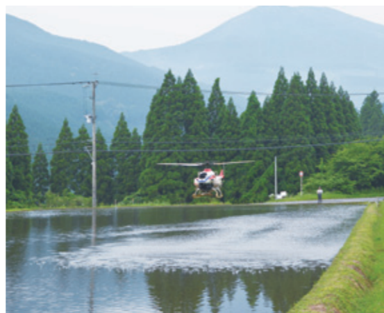
写真3 鉄コーティング種子の無人ヘリによる散播 初期除草剤も播種時に散布され、作業効率は高い
