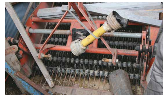
葉を刈り取った後、収穫機を使い、土を掘り起こしながら収穫します。機械はたまねぎの収穫機にヒントを得て改良されたものを購入したそうです。
